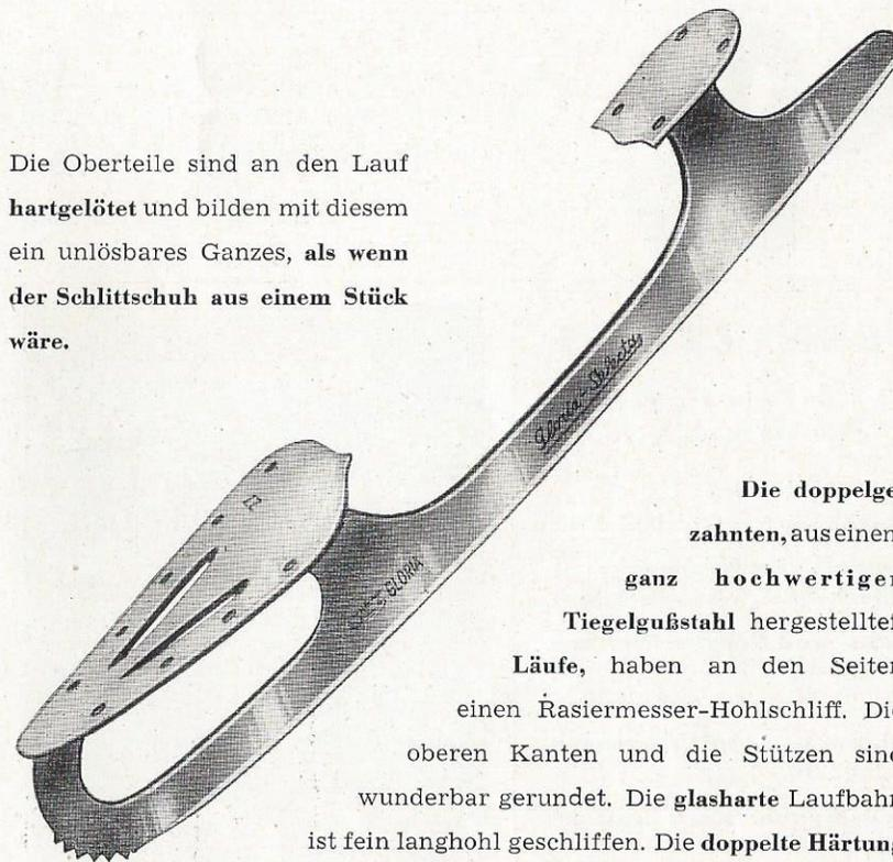
Die **doppelgezahnten, aus einem ganz hochwertigen Tiegelgußstahl** hergestellten **Läufe**, haben an den Seiten einen Rasiermesser-Hohl-schliff. Die oberen Kanten und die Stützen sind wunderbar gerundet. Die **glasharte** Laufbahn ist fein langhohl geschliffen. Die **doppelte Härtung** gibt dem Lauf **außerdem eine tadellose Federhärte.**
