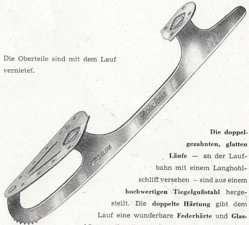
Die doppelgezahnten, glatten Läufe — an der Laufbahn mit einem Langhohl-schliff versehen — sind aus einem hochwertigen Tiegelgußstahl hergestellt. Die doppelte Härtung gibt dem Lauf eine wunderbare Federhärte und Glas-härte an der eigentlichen Laufbahn.
